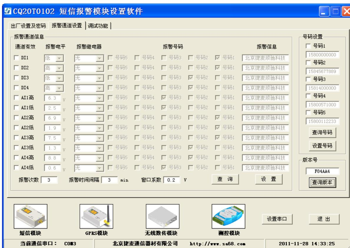
1. 在右边的填写需要报警的号码，勾选标号，点击设置号码，完成对报警号码的设置；
