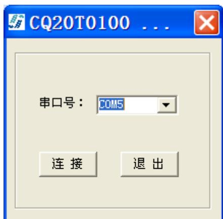
点击连接后，显示与下图所示的界面，点击查询，报警器的有关参数显示。
